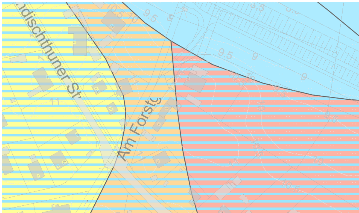
Abb. 4: Bodenkarte von Niedersachsen (BK50); Bodentypen im Plangebiet: Mittlerer podsolierter Gley-Regosol und Mittlere Gley-Braunerde; Quelle: NIBIS Kartenserver
